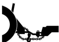
Al acoplar el equipo al tractor, use siempre una cadena para trabar la cabecera del equipo a la barra de tracción del tractor. Esta medida evitará que las mangueras hidráulicas se rompan o el equipo se empina en caso de rotura del sistema de enganche.
