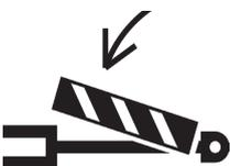
Siempre utilice las trabas para efectuar el mantenimiento y el transporte de los equipos.
